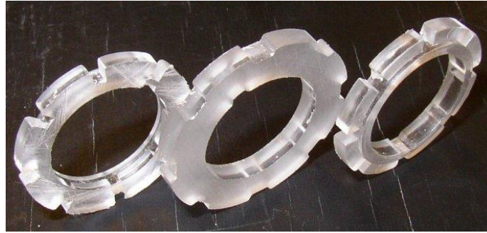
9. ábra. Szeletelt PC alaptest, feszültéoptikai vizsgálatra kész állapotban
