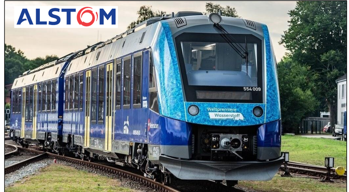
Alstom Coradia iLint zero emissziós hidrogénhajtású vonat
