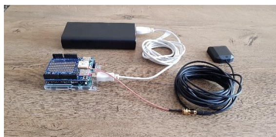
2. ábra. Prototípus B: MediaTek MTK 3339 felépítése
