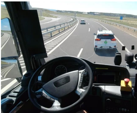
16. ábra. Sáv váltó asszisztens funkció SciL teszthez robotizált valós járművekkel
