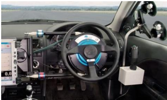
15. ábra. Vezetőrobottal ellátott forgalmi partner
