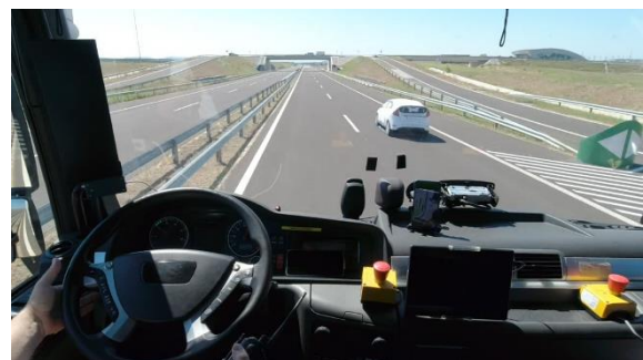
14. ábra. Sávváltó asszisztens funkció SciL tesztje nagyteherbírású tesztplatformmal [7]
