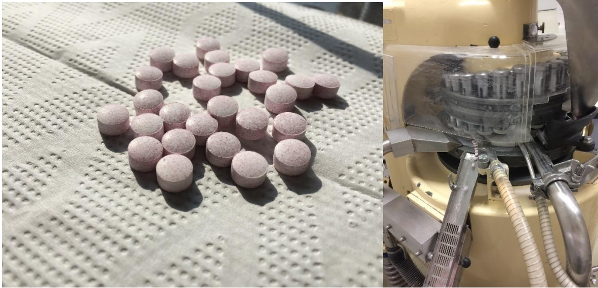
1. ábra: Mini pezsgőtabletták és gyártásuk körforgós tablettázógéppel
