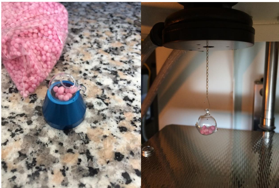
4. ábra: Nedvességmegkötés és -leadás vizsgálati elrendezése IgaSorb berendezéssel
