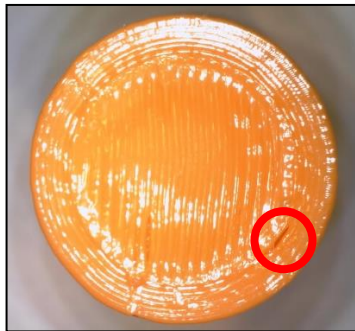
8. ábra: Nyomtatási hiba Megjegyzés: 0,4 mm rétegvastagság, álló tájolás
