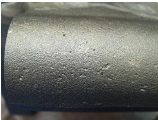
2. ábra. Öntési hibák a munkadarabon
