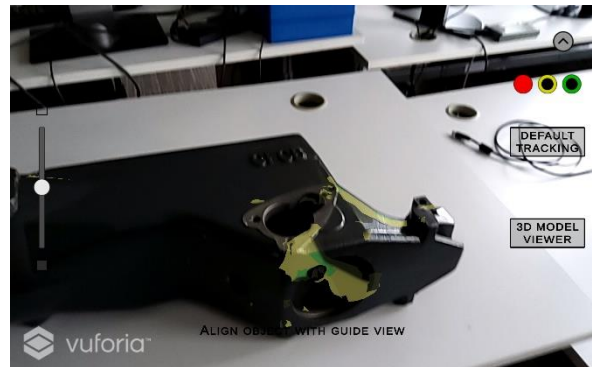
6. ábra. A tablet verzió képe a nagy méretű öntvény tesztelése közben
