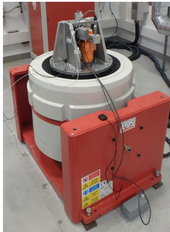
6. ábra. Az adatgyűjtő mérőrendszer tesztelése rázópadon
