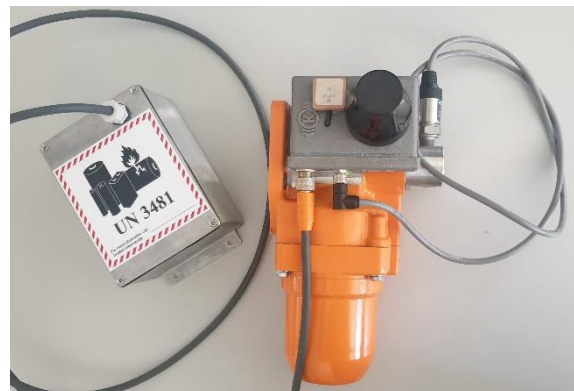
5. ábra. Az összeállított adatgyűjtő rendszer akkumulátorral (a rugalmas tömlő nélkül)
