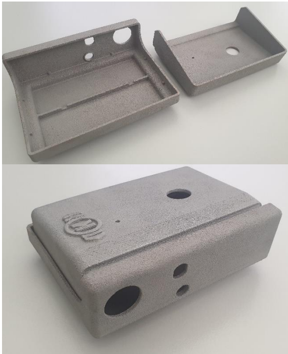
3. ábra. 3D-nyomtatott alumínium ház a főegységhez
