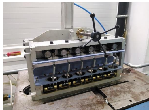
10. ábra. Fárasztógép és a beszerelt egységek
