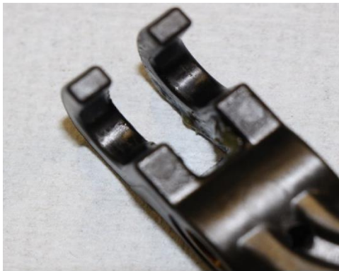
12. ábra. Elhanyagolható mértékű kopás a villában
