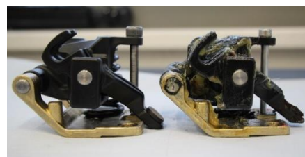
11. ábra. Fárasztás előtti és utáni állapot
