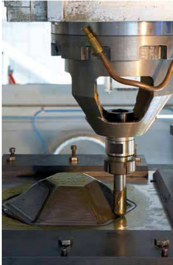
Inkrementális lemezalakítás robottal
