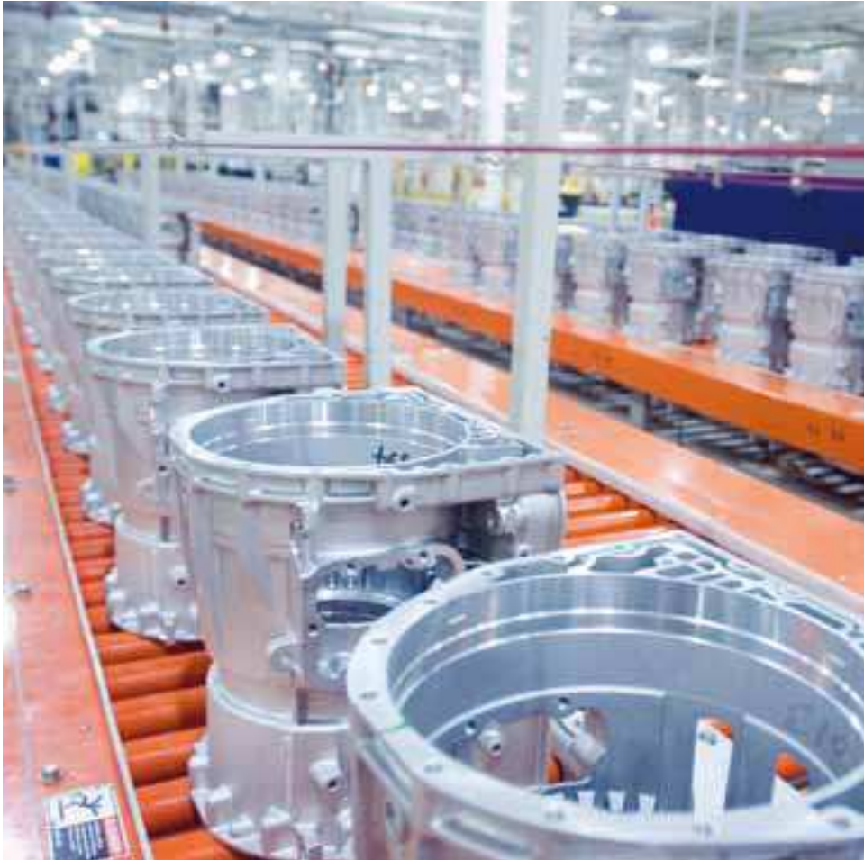
Aluminium sebességváltó házak gyártása
