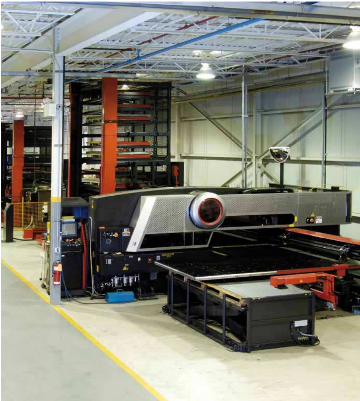
Lemezalkatrészek laser kivágó technológiája
