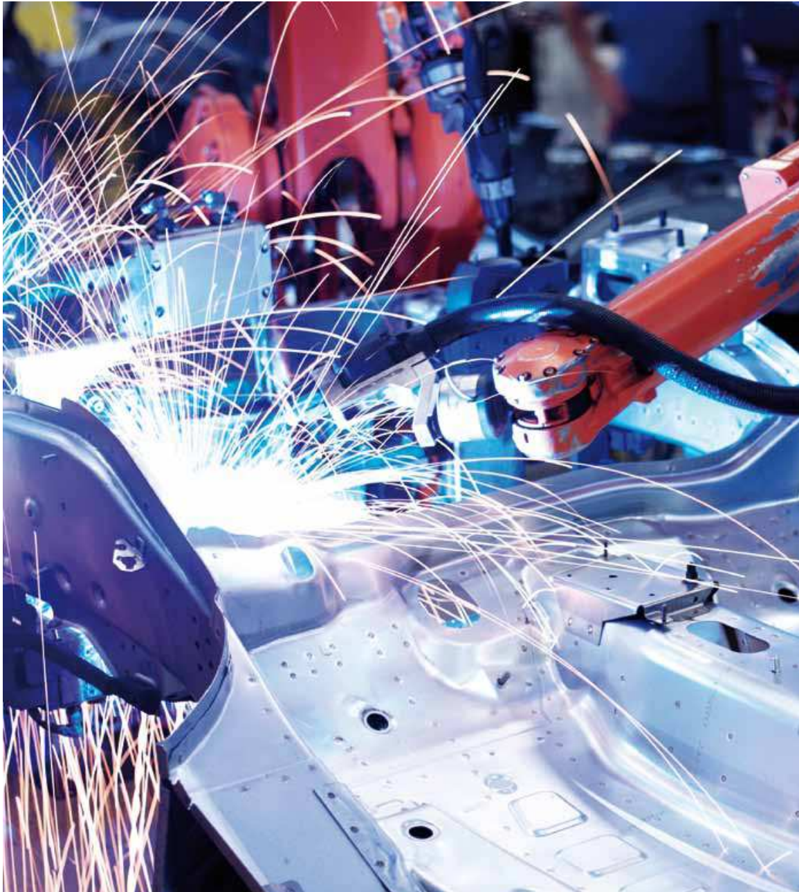
Autó karosszéria elemek robotos hegesztése
